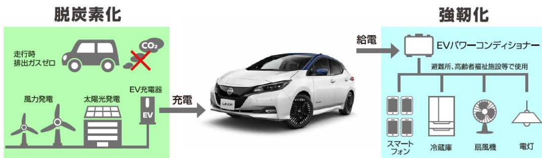
「電気自動車「日産リーフ」を活用した脱炭素化、強靱化イメージ」
