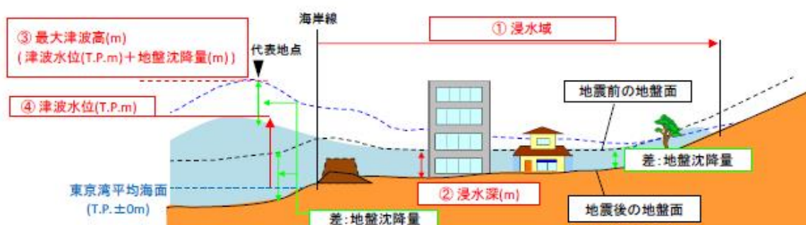
図-2 各種高さの模式図 (三重県)
