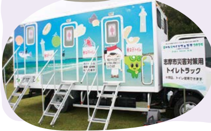
◀ 災害対策用トイレトラック 5つの洋式トイレ、給水タンク、汚水タンク、ソーラーパネルを備え災害時にすぐ使用できる機能が備わっており、電動車いすリフターにより車いすの方も使用できます
