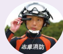
AIスマートグラス 隊員位置、移動軌跡、隊員カメラ映像の共有が可能
