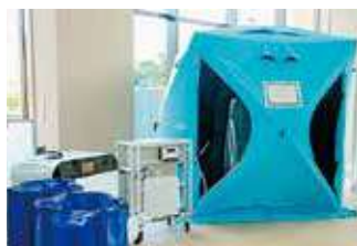
水循環型シャワー
