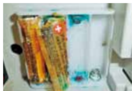
乾電池の液漏れにより 故障した戸別受信機
