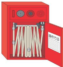
【屋内消火栓設備】
